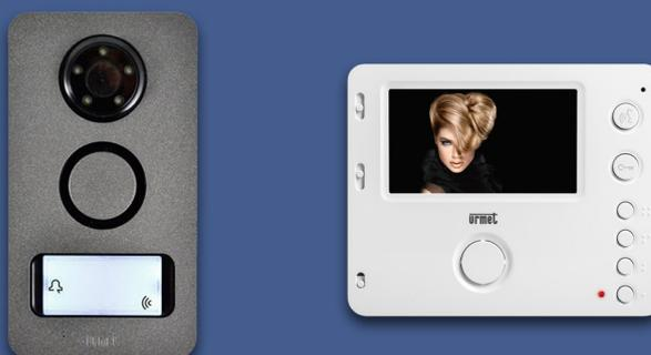
**1722/84 - souprava domovního videotelefonu pro 2 účastníky**, hands-free videotelefony **MIRO**, panel antivandal **MIKRA**, zdroj na DIN lištu, 2 vodiče, možnost až 3 paralelních videotelefonů (1722/88) s funkcí **interkomu**, podpora automatizace **Yokis**, možnost připojení modulu pro přesměrování hovoru na **Android** zařízení.
